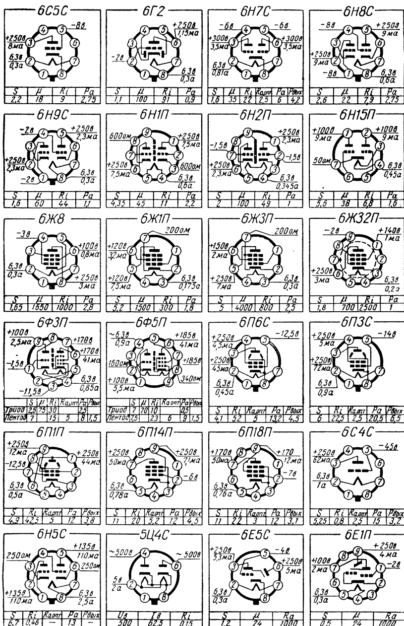
Рис. 80. Параметры и схемы цоколевки некоторых электронных ламп.
