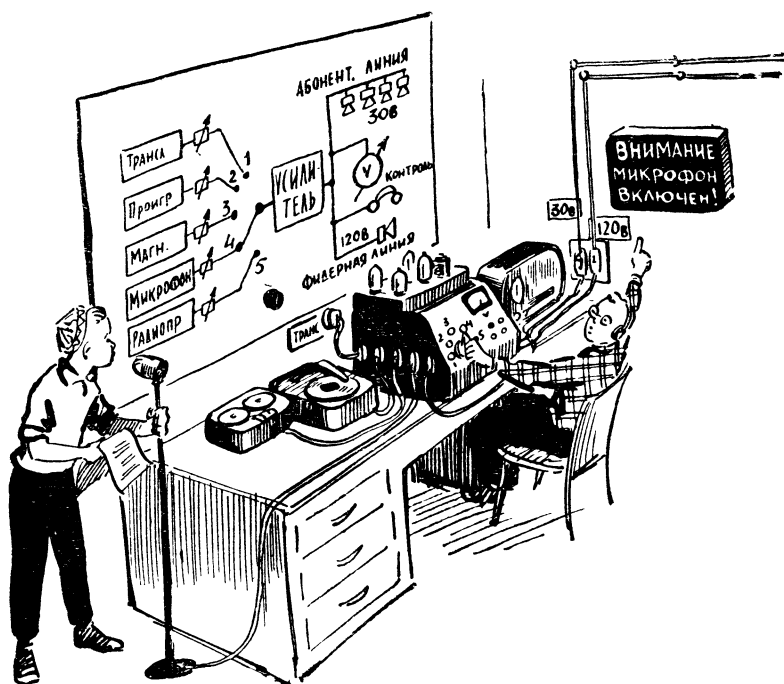
Рис. 67. Радиоузел представляет собой обычный усилитель низкой частоты с необычными входными и выходными цепями; ко входу могут подключаться различные источники сигнала (микрофон, звукозаписывающий аппарат, приемник, трансляционная линия, магнитофон), а к выходу — различные потребители (группы абонентских громкоговорителей, мощные рупорные громкоговорители, звуковые колонки).
